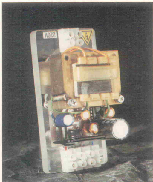
Bild 4. Das Mini-Netzteil liefert drei Ausgangsspannungen.
