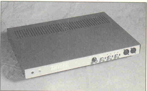
Bild 10. Der TEF 20 von Techron: Seine Domäne sind Laut- sprecher- und Akustik- messungen.
