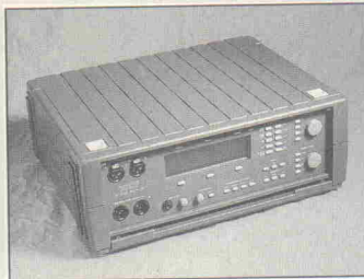
Bild 15. Das Portable One Plus von Audio Precision schützt seine Bedienelemente durch ein stabiles Schalengehäuse.
