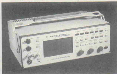
Bild 14. Das Neutrik A1 ist untergebracht in einem HF-dichten Alugehäuse.
